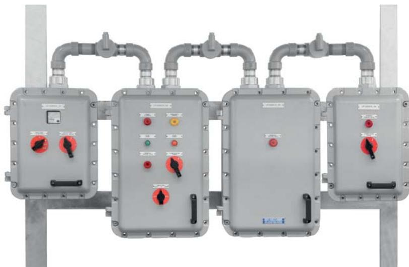
Габариты имеющихся корпусов ограничены и их не всегда достаточно для реализации поставленной задачи согласно техническому заданию. В таких случаях шкаф представляет собой модульную структуру из нескольких корпусов, соединенных между собой элементами трубной проводки или металлорукавом. Использование такого подхода позволяет сократить габариты, массу и стоимость шкафа.
