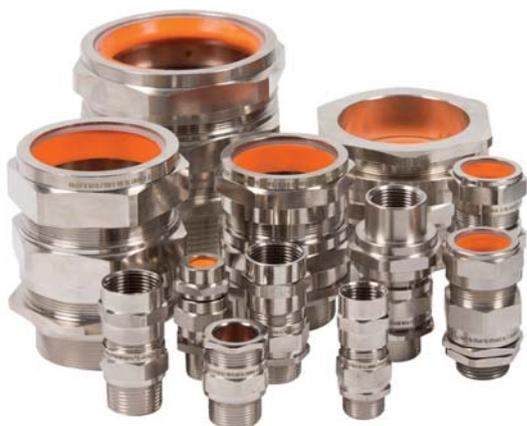
Кабельные вводы взрывозащищенные **серии HL\*\*** предназначены для уплотнения и фиксации гибких и бронированных кабелей круглого сечения при вводе их в стационарное, передвижное или переносное электрооборудование в помещениях и наружных установках (группа II) соответственно для взрывоопасных зон 0 – 1 – 2.
