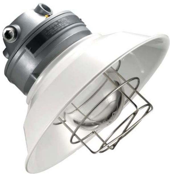
Взрывозащищенные светильники **ГЕЛЕКС** предназначены для промышленного применения во взрывоопасных средах в помещениях и наружных установках (группа II) с содержанием газа и горючей пыли соответственно для взрывоопасных зон 1 – 2.
