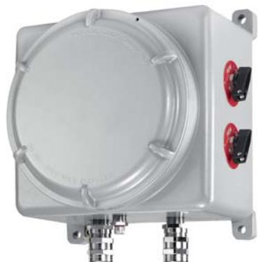
Корпуса **УНВ(С) с резьбовым соединением** предназначены для промышленного применения во взрывоопасных средах в помещениях и наружных установках (группа II) с содержанием газа и горючей пыли соответственно для взрывоопасных зон 1 – 2.
