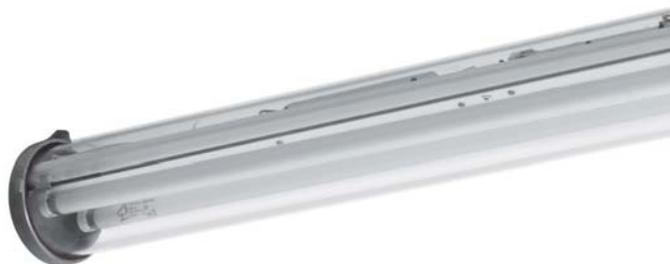
Светильники серии EVFG и EVFGD представляют собой цилиндрический корпус из термостойкого боросиликатного стекла с повышенной механической прочностью. Торцы корпуса светильника изготовлены из коррозионностойкого модифицированного алюминиевого сплава и закрыты торцевыми крышками из того же материала.
