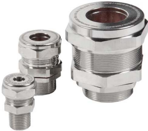
Кабельные вводы взрывозащищенные **серии K\*\*** предназначены для уплотнения и фиксации гибких и бронированных кабелей круглого сечения при вводе их в стационарное, передвижное или переносное электрооборудование в помещениях и наружных установках (группа II) соответственно для взрывоопасных зон 0 – 1 – 2.
