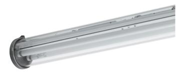
Светильники серии EVFG и EVFGD представляют собой цилиндрический корпус из термостойкого боросиликатного стекла с повышенной механической прочностью. Торцы корпуса светильника изготовлены из коррозионностойкого модифицированного алюминиевого сплава и закрыты торцевыми крышками из того же материала.
